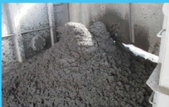
脱水ケーキ(脱水後の固体) 脱水ケーキ含水率 48%
